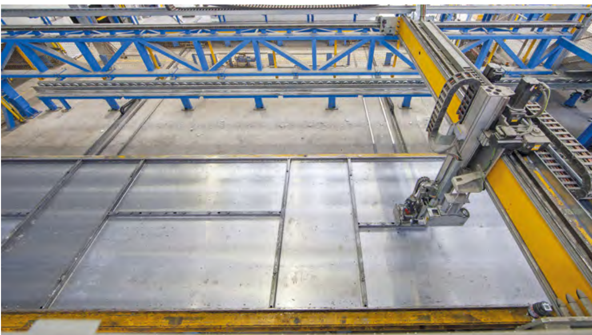
Moderne Anlagen sorgen bei der Betonfertigteilterstellung für hohe Maßgenauigkeit und kontrollierte Produktionsbedingungen.
