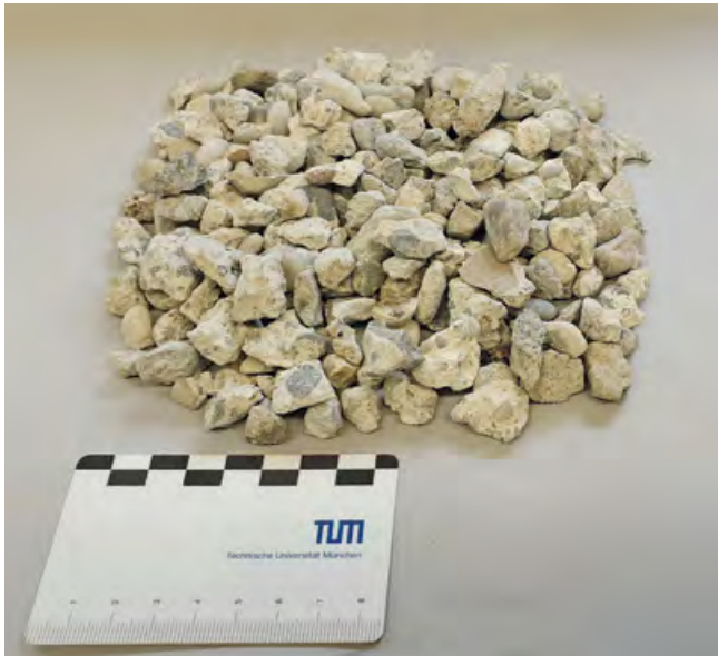
Aufbereitete RC-Beton-Gesteinskörnung 8/16 (Typ 1 nach DIN 4226-101; Mindestanteil der Stoffgruppe „Beton“ beträgt 90 M.-%).
