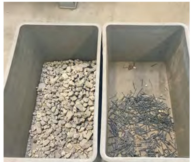
Ergebnis kamerabasierte Sortierung von Carbonbetonabbruchmaterial.
