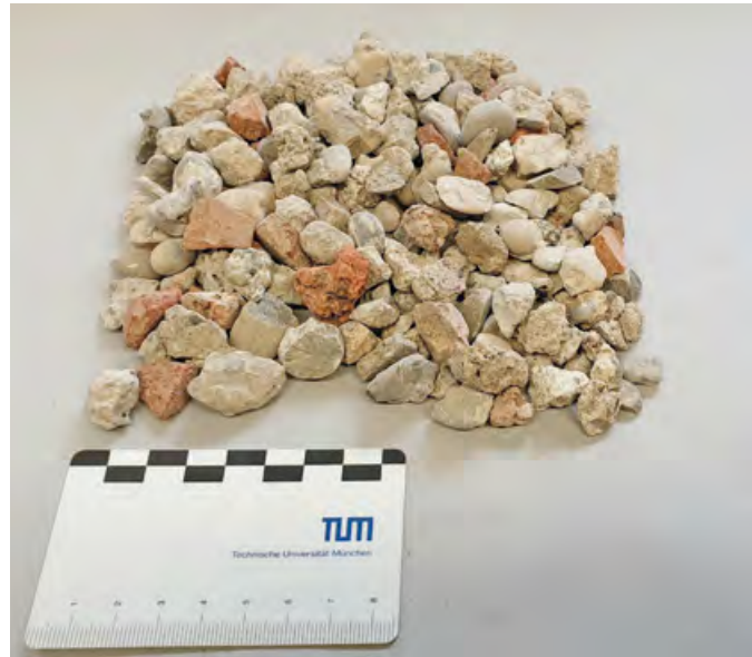
Aufbereitete RC-Beton-Gesteinskörnung 8/16 (Typ 2 nach DIN 4226-101; Mindestanteil der Stoffgruppe „Beton“ beträgt 70 M.-%).
