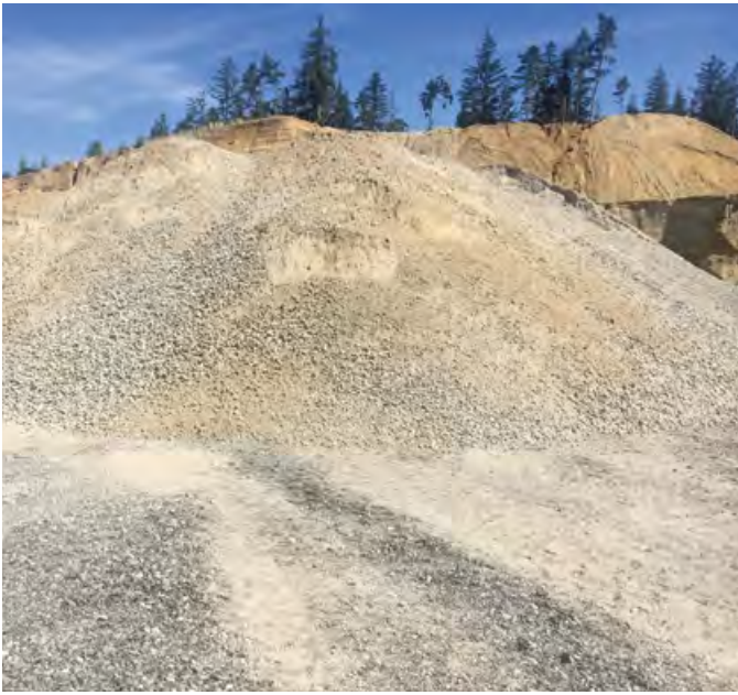
Aufbereitetes sortenreines RC-Beton-Baustoffgemisch 0/63 (Mindestanteil der Stoffgruppe „Beton“ beträgt 90 M.-%).
