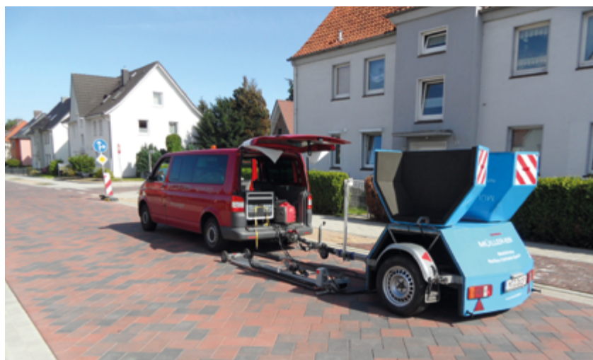
Bild 1: Messung der Rollgeräuschemission mit dem so genannten CPX-Messanhänger auf einer Betonpflasterdecke.
