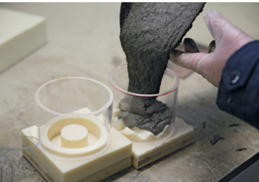
„Non-Waste-Wachsschalungen“: Neuartige Präzisions-Schalungen aus 100 % recycelbaren Industrie-Wachsen zur Herstellung von geometrisch komplexen Betonbauteilen.
